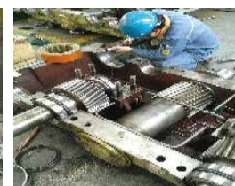
大型减速箱离线检修
